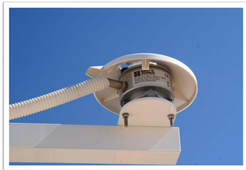
Figure3-6: Kipp&ZonnenPyranometer installed at Adam
